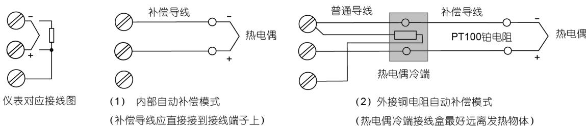
注：AI-8\*9系列外接补偿端子为输入公共负极(COM)和CJC端子(A/E等尺寸为20号端子，D71尺寸为13号端子)
