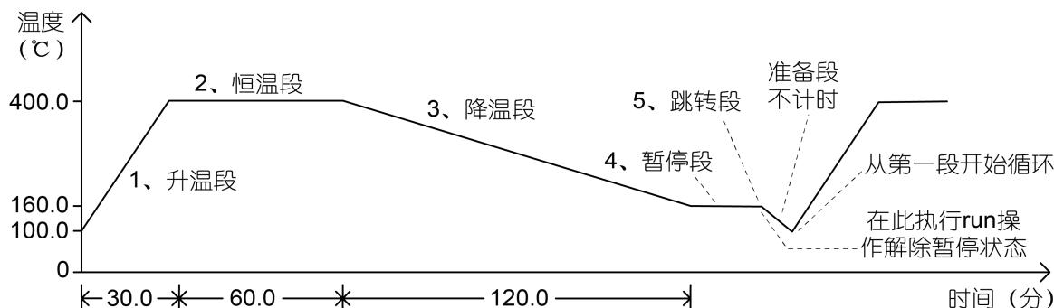
采用温度~时间编程方法的优点是升温、降温的斜率设置的范围非常宽。升温及恒温段具有统一的设置格式，方便学习。设置曲线更灵活，可以设置连续设置升温段(如用不同斜率的升温段近似实现函数升温)，或连续的恒温段。
