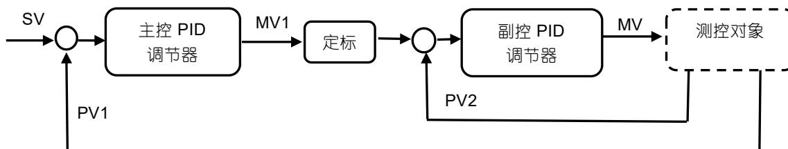
上图中 **SV** 为客户输入的给定值，**PV1** 为主控测量值，**PV2** 为副控测量值，**MV1** 为主控输出值，经过定标后作为副控给定值，**MV** 为仪表给执行器的输出值。测控对象为工业炉，通常要求系统传感器安装时，要满足 **PV2** 的滞后时间要小于 **PV1** 的滞后时间，方可采用串级控制方式来改善整体控制效果。
