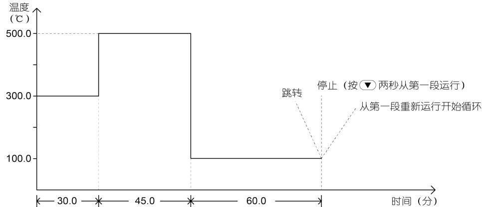
平台模式只要设置温度和恒温时间就可以，不需要设置升温过程，上图提示中，可以设置跳转，停止，循环等等，以上设置实列为停止。
