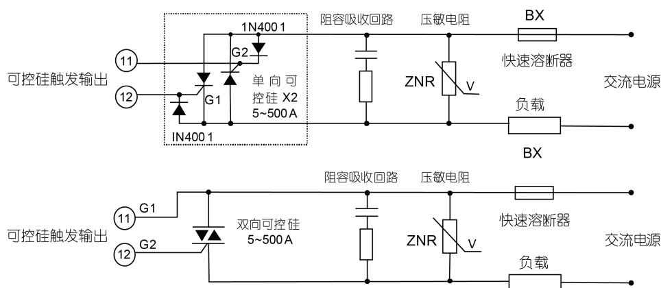
注 1：采用移相触发时必须加阻容吸收及压敏电阻以改善可能产生的谐波干扰。
